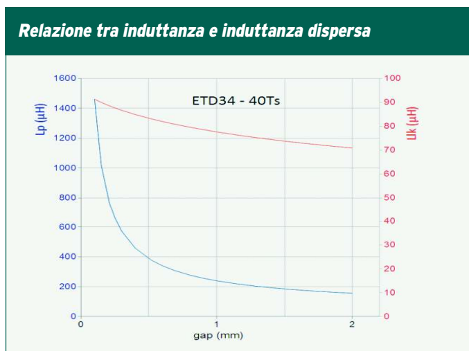
Figura 2 Esempio di relazione tra induttanza e induttanza dispersa
